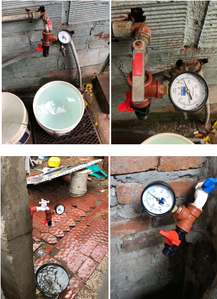
Imágenes de la campaña de medición de presión en canillas conectadas a las redes públicas de agua del barrio
